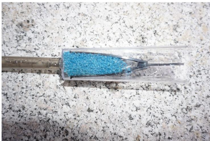
Mit einem kleinen Stück Filterschwamm lässt sich der Mulmsauger auch für kleine Fische und Garnelen sicher machen.
