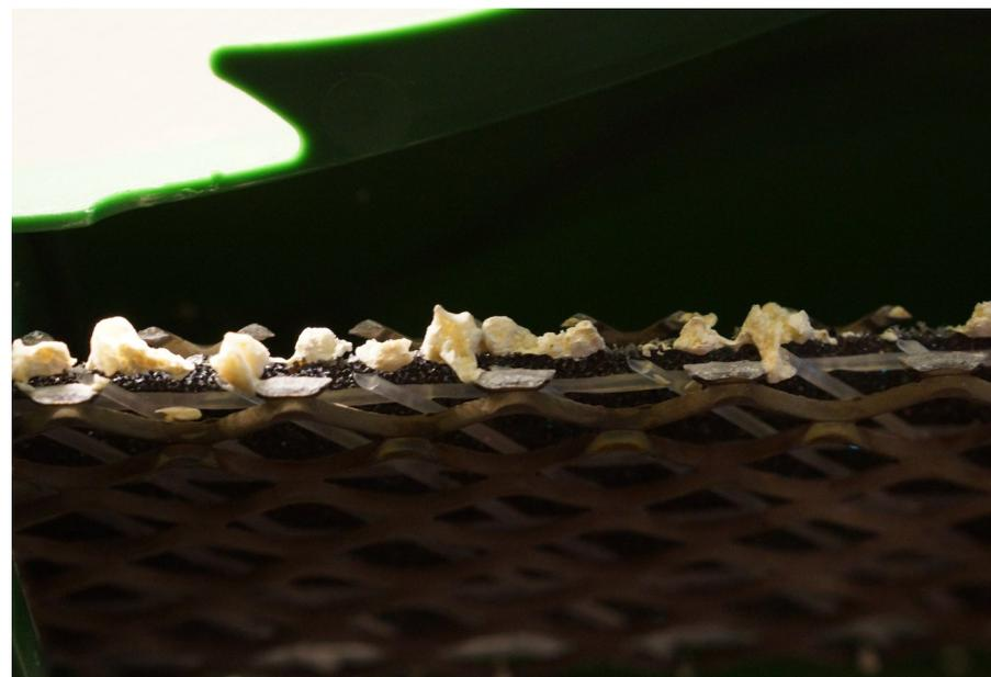
Die obere Fläche des Aktivelements nach einigen Wochen Testbetrieb in unterschiedlichen Sprudelstärken. Diese Ablagerungen können mit der beiliegenden Reinigungstablette (Reinigungstabletten für Kaffeemaschinen gehen sicherlich auch) entfernt werden. Laut Beschreibung empfiehlt sich ein monatlicher Reinigungsvorgang, aber dies hängt sicherlich auch von der Wasserhärte im Aquarium ab. Man sollte besonders in der Anfangszeit ein Auge darauf haben.
